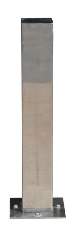
Dissuasore di sicurezza antisfondamento vetrine Cuadrada in acciaio inox da 120x120 mm con anima interna in ferro rinforzato da 100x100x4 mm. Possibilità di riempire l'interno con cemento, sabbia o ghiaia per rinforzarlo ulteriormente.
