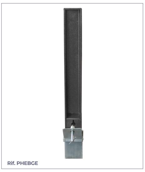
**Dissuasore HEB rimovibile** costituito da una trave di ferro di 100x100 mm. Altezza totale 1000 mm. Base di fissaggio a terra zincata per il fissaggio del dissuasore con serratura universale.
