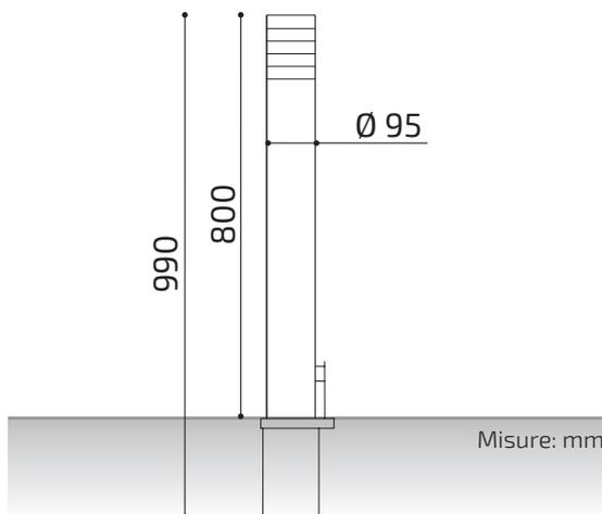
**Dissuasore rimovibile modello Flag**, costruito con tubo di acciaio, diametro di 95 mm e spessore di 2,5 mm. Altezza totale: 990 mm I cerchi colorati sono intercambiabili a seconda delle esigenze del cliente.
