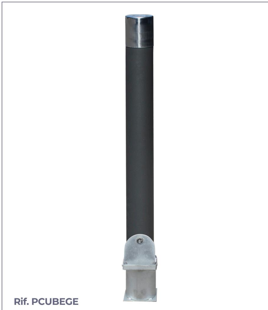
**Dissuasore rimovibile Cube** dalla forma semplice e cilindrica, costruito in acciaio zincato e ossiron o imitazione corten. Cappuccio superiore in acciaio inox. Base zincata di ancoraggio al pavimento per il posizionamento del dissuasore con serratura universale.
