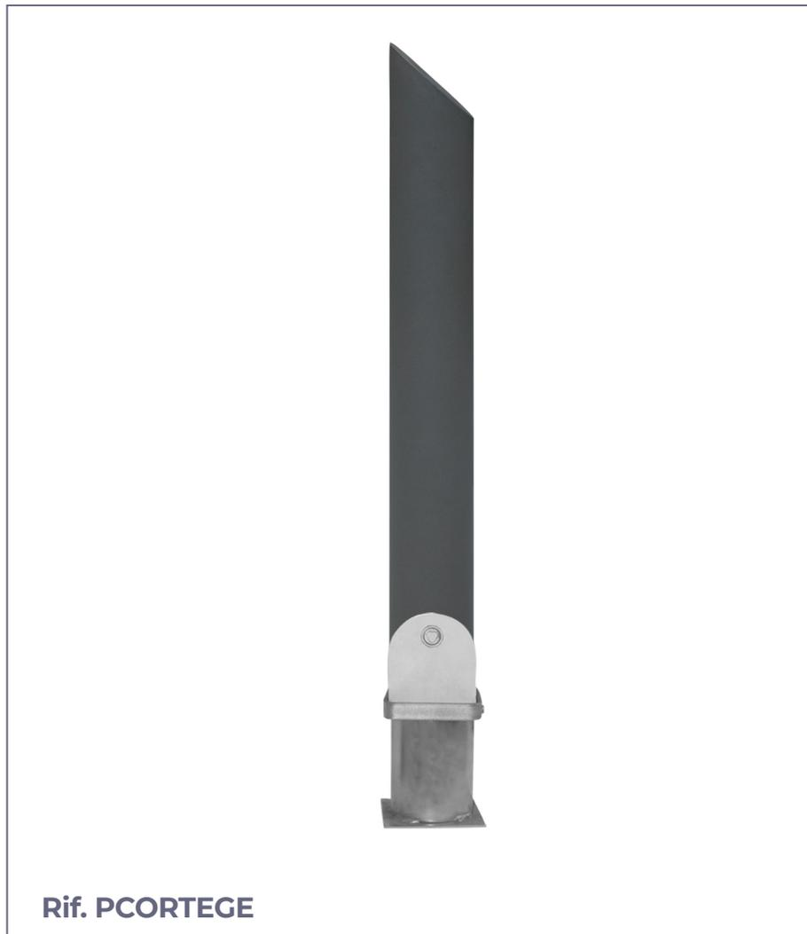
**Dissuasore rimovibile con taglio superiore tipo flauto**, costruito con tubo di acciaio zincato dal diametro di  $\varnothing$  95 o 200 mm e spessore di 2,5 mm. Altezza totale: 1000 mm.
