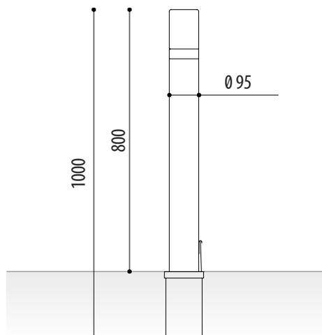
**Dissuasore modello Barcelona** realizzato con tubo di acciaio dal diametro di  $\varnothing$  95. Altezza totale: 1000 mm. Con anello in acciaio inox nella parte superiore. Parte superiore con bordi arrotondati per evitare di provocare danni a persone.
