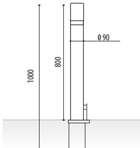
**Dissuasore modello Barceco** in tubo di ferro  $\varnothing$  90 e spessore 2,0 mm. Altezza totale 1000 mm. Con anello in acciaio inox nella parte superiore. Testa con bordi arrotondati per evitare possibili lesioni alle persone.
