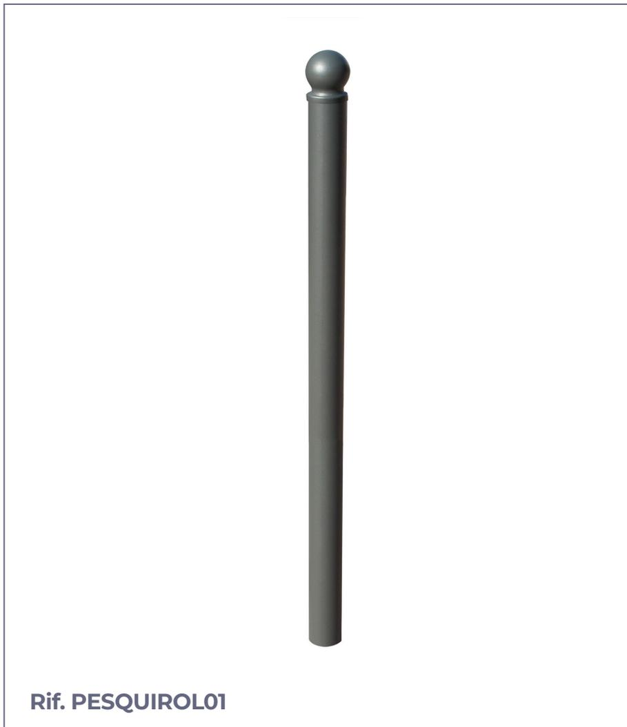
**Dissuasore modello Esquirol** in acciaio laccato grigio costruito con tubo  $\varnothing$  60, 76 o 90 mm e spessore 2 mm. Altezza totale di 1000 mm.
