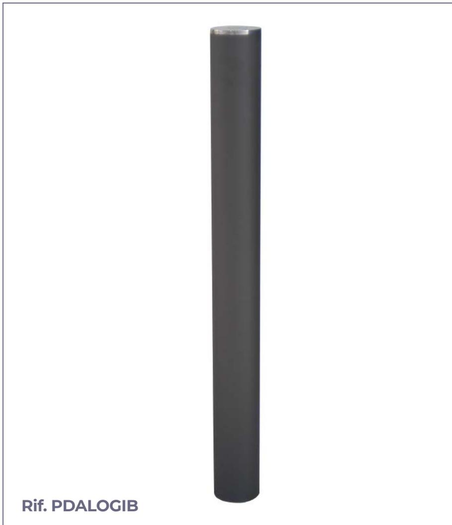
**Dissuasore modello Dalo** costruito con tubo di acciaio, diametro di  $\varnothing$  95 o 200 mm e spessore di 2,5 mm. Con coperchio superiore in acciaio inox di 8 mm.
