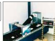
Sono stati eseguiti più di 2.000 cicli di piegatura senza la comparsa di crepe sulla superficie del dissuasore, che ritorna nella sua posizione originale dopo l'applicazione della forza necessaria per piegarlo a 90°.
