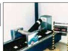
Sono stati eseguiti più di 2.000 cicli di flessioni senza la comparsa di crepe sulla superficie del dissuasore, che ritorna nella sua posizione originale dopo l'applicazione della forza necessaria per piegarlo a 90°.
