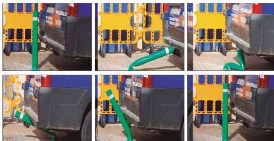
*Le proprietà di questo materiale consentono al dissuasore di tornare alla sua forma e posizione originale in caso di impatto. Non si spezzano, non si ammaccano e non arrugginiscono.*
